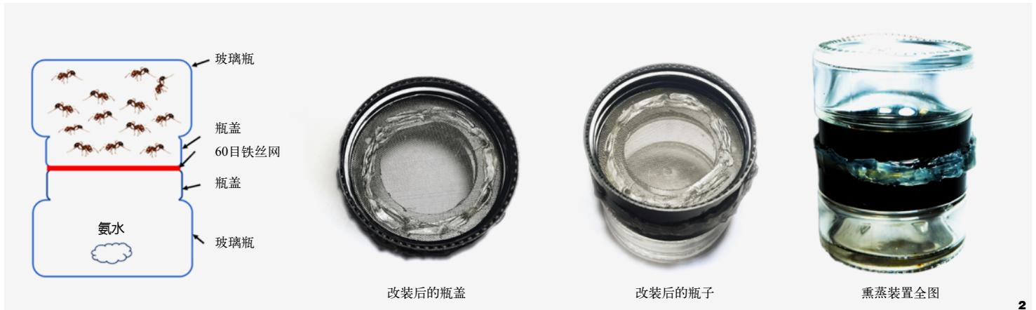
图2 测定氨气对红火蚁熏蒸毒力试验设备
